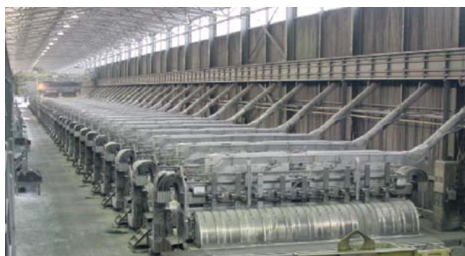
Obrázek 2 – Pohled na elektrolyzéry ve výrobě primárního hliníku
