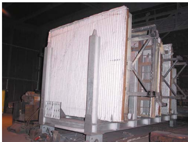
Obrázek 6 – Vyzdívka pecních vrat provedená systémem PROMACOMB®-1260/180
