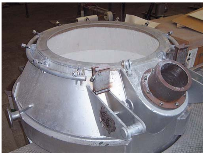
Obrázek 5 – Transportní pánve pro tekutý hliník
